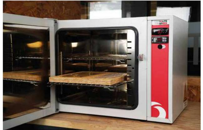
Par le test Martindale, nous étudions la résistance à l'usure et à la rupture de nos membranes. Avec les fours et les chambres à basse température, nous testons le comportement de nos produits lorsqu'ils sont exposés à des températures extrêmes.
