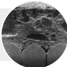
Image au microscope d'une membrane monolithique sectionnée.
