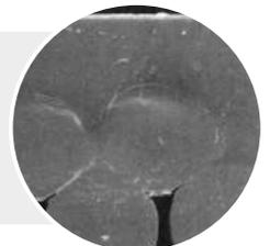
Les films **microporeux** sont réalisés avec des polymères hydrophobes, eux-mêmes incapables d'interagir avec l'eau et la vapeur. **Pour rendre le film respirant, des procédés spéciaux** sont nécessaires, bien qu'ils le rendent plus rigide et plus sensible aux polluants.
